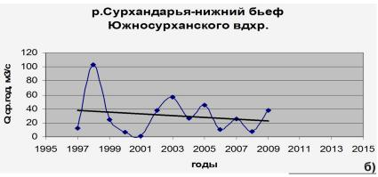
Рисунок 1. Многолетние изменения среднегодовых расходов воды бассейна р.Сурхандарьи с проведением линии тренда: а) створ Шурчи, б) створ н.б. Южносурханского вдхр.
