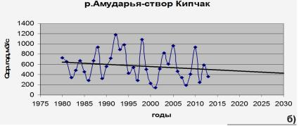
Рисунок 3. Многолетние изменения среднегодовых расходов воды бассейна р.Амударьи с проведением линии тренда: а) створ – теснина Тюямуюн, б) створ Кипчак
