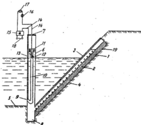
Изобретение относится к области измерения уровней и может быть использовано при управлении уровнями воды в каналах при автоматизации работы насосных станций.
