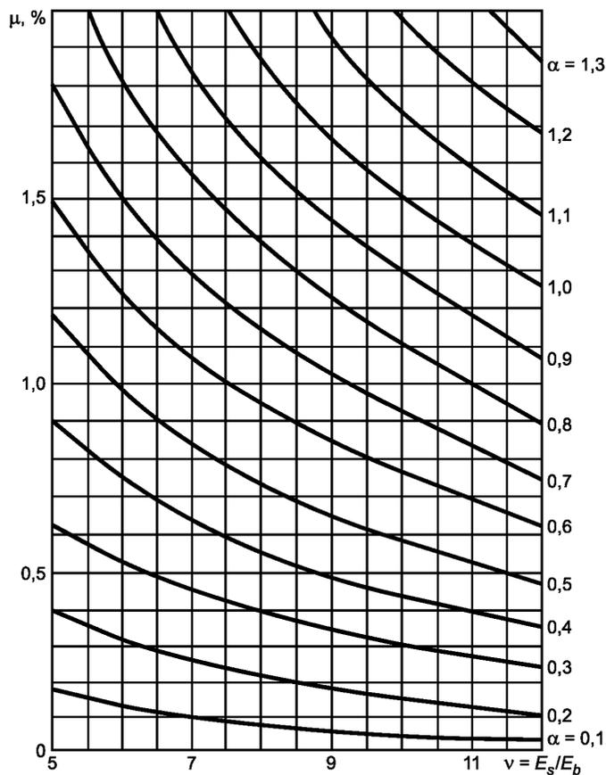
Рисунок Е.1 — Номограмма для определения коэффициента жесткости
