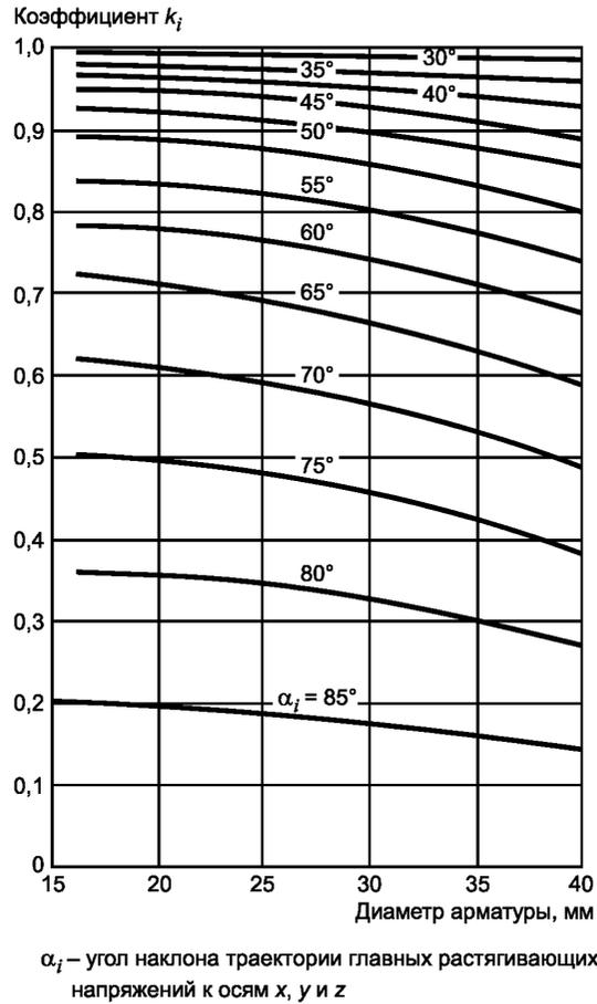
Рисунок Д.1 — Номограмма для определения коэффициента  $K_i$
