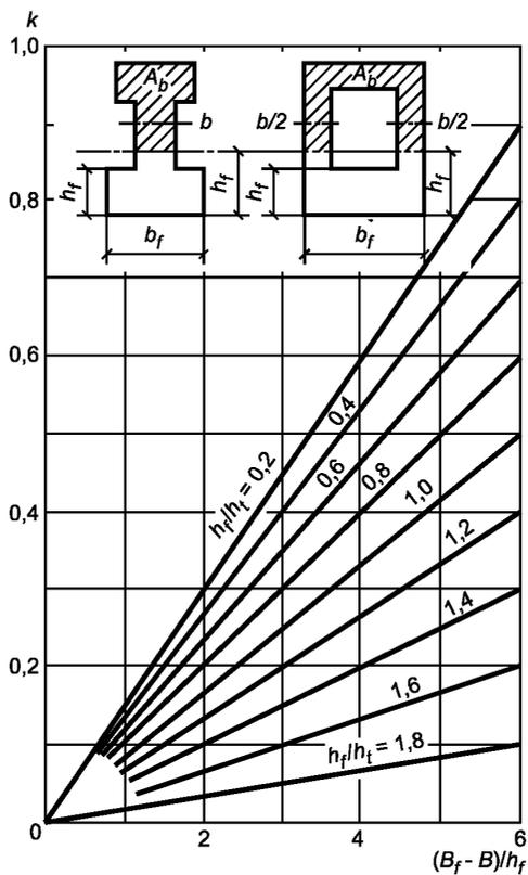
Рисунок Г.1 — Номограмма для определения коэффициента  $k$
