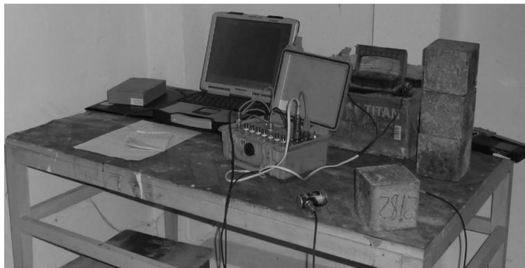
**Рисунок 1 – Образцы бетона, залитые при строительстве Богучанской гидроэлектростанции (фото Л. С. Василевской)**
