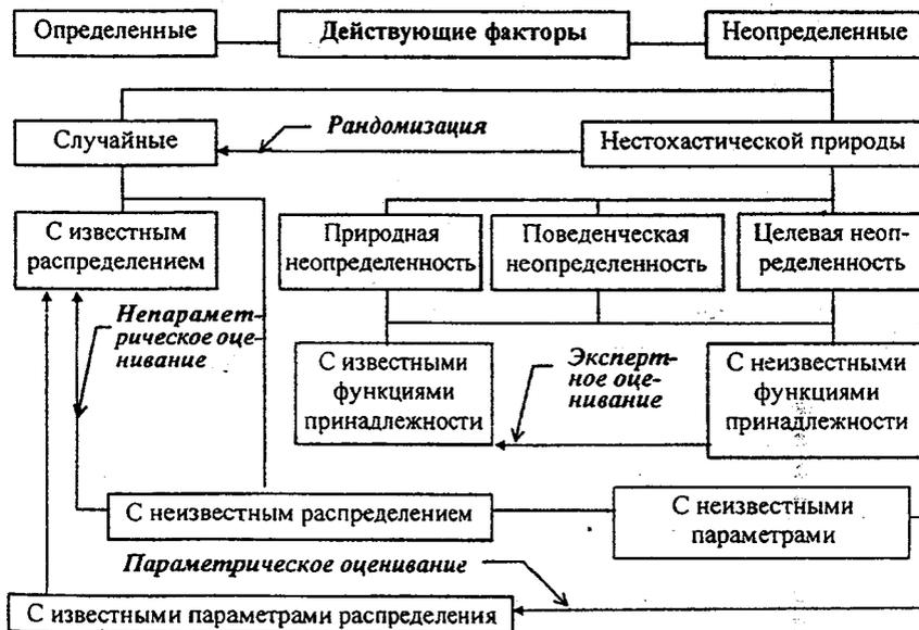
Рисунок - 3. Общая схема вероятностного моделирования факторов, определяющих надежность и безопасность гидротехнических объектов.
