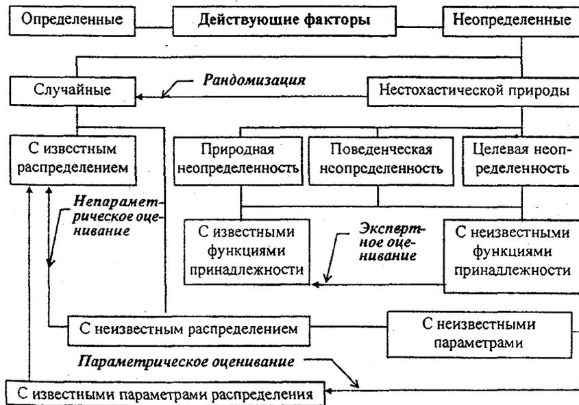
Рисунок - 3. Общая схема вероятностного моделирования факторов, определяющих надежность и безопасность гидротехнических объектов.
