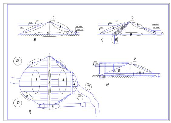
Возможные зоны дефектов, деформаций и повреждений для грунтовых плотин:  $a, \delta$  – земляная однородная плотина;  $\epsilon$  – земляная плотина с экраном,  $\epsilon$  – трубчатый башенный водосброс в теле плотины
