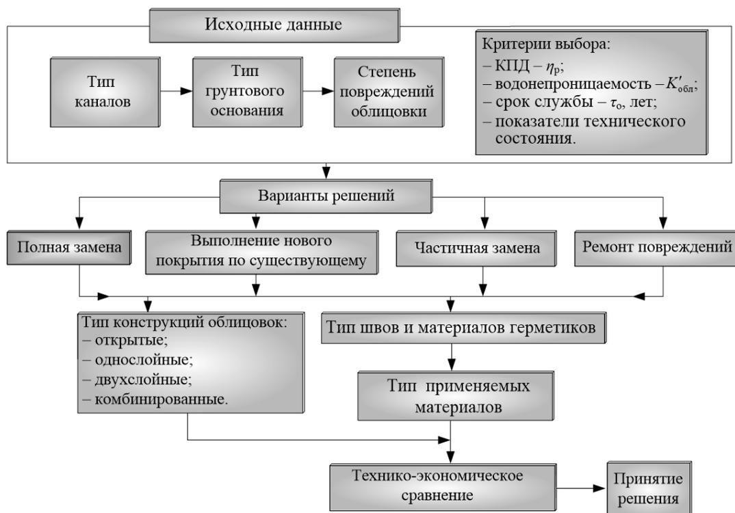
**Рисунок 5 – Алгоритм выбора варианта восстановления бетонных облицовок каналов**
