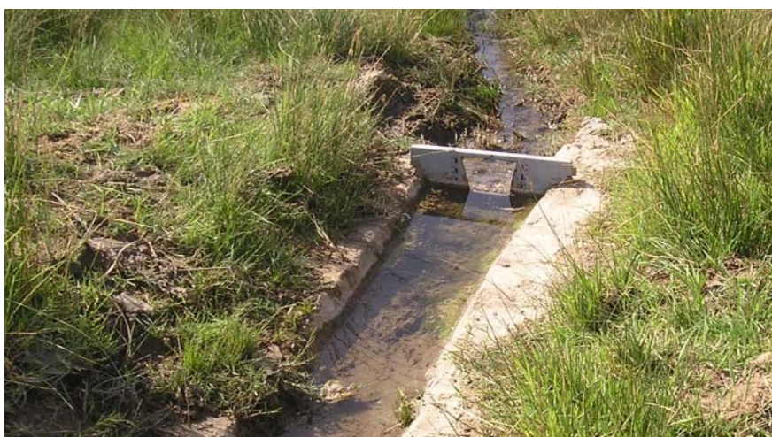
Рисунок 3 - Водомер для измерения фильтрационного расхода.
