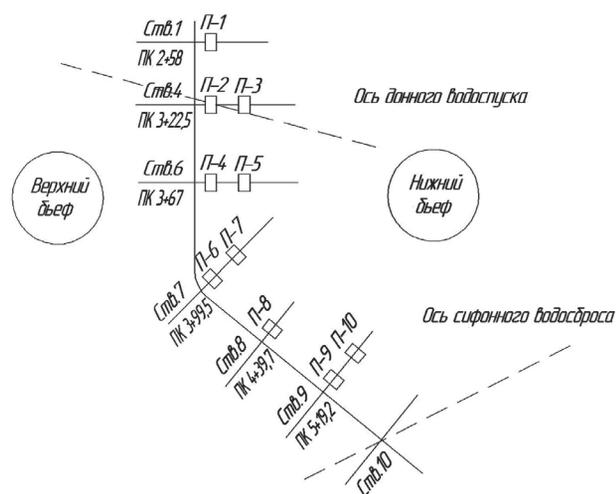
Рис. 1 Схема расположения пьезометров на Таналыкской плотине
