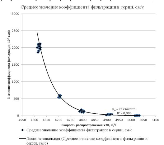
Рисунок 1 - Зависимость между скоростью распространения УЗК и водонепроницаемостью бетона
