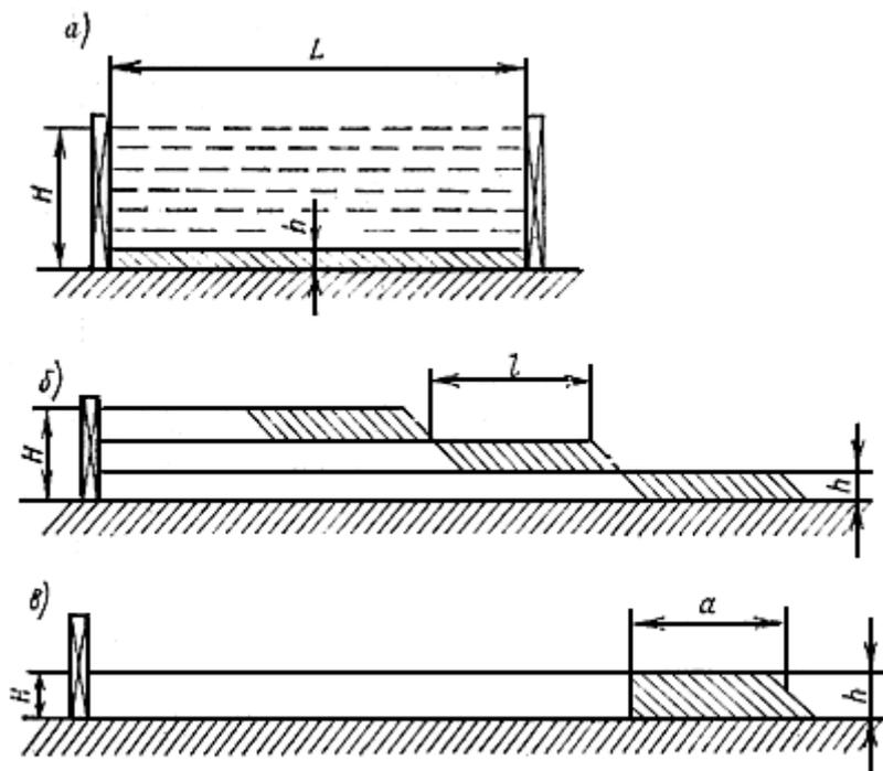
Основные схемы укладки бетонной смеси в блоки
