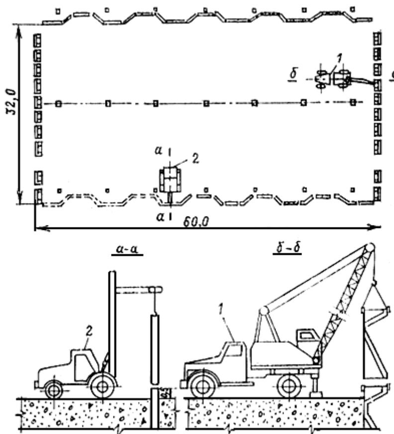
Схема раскладки опалубки межблочных швов
