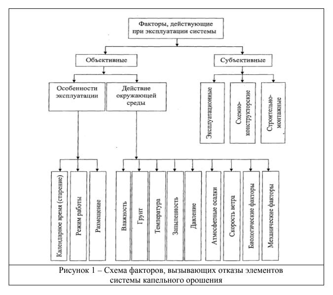
В факторе режим работы учитывается периодичность работы системы. Частое включение и выключение насосных агрегатов нежелательно. При этом может возникнуть отказ, как пускателя, так и электродвигателя. Поэтому при назначении сроков и норм поливов необходимо учитывать этот фактор.
