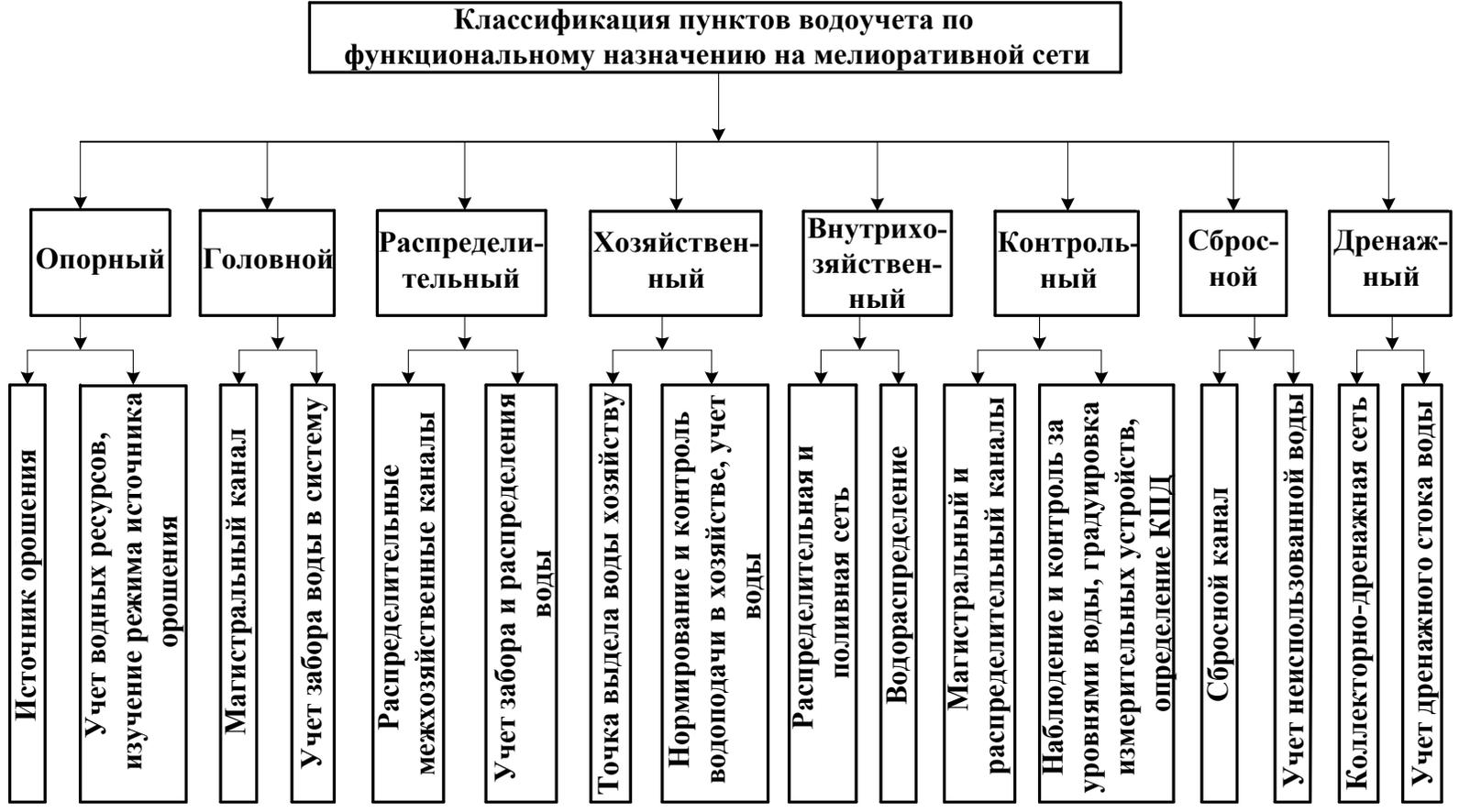
**Рисунок 1 – Схема классификации пунктов водоучета на мелиоративной системе по их функциональному назначению**
