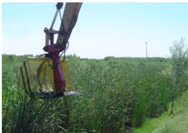
**Рис 2. Ковш-косилка с пальцевым режущим аппаратом**
