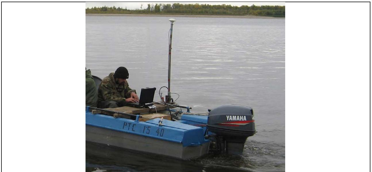
Рисунок 2 - Система ADP RiverSurveyor установлена на моторной лодке. На верхнем конце штанги - антенна GPS приемника, на нижнем - датчик системы
