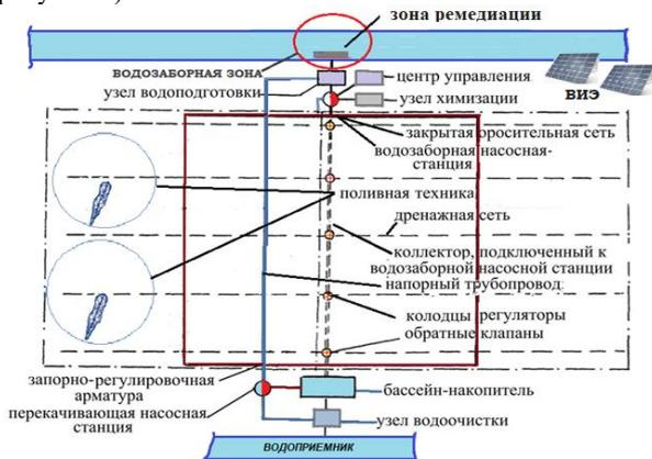
Рисунок 1 – Типовая оросительная система с ШДМ
