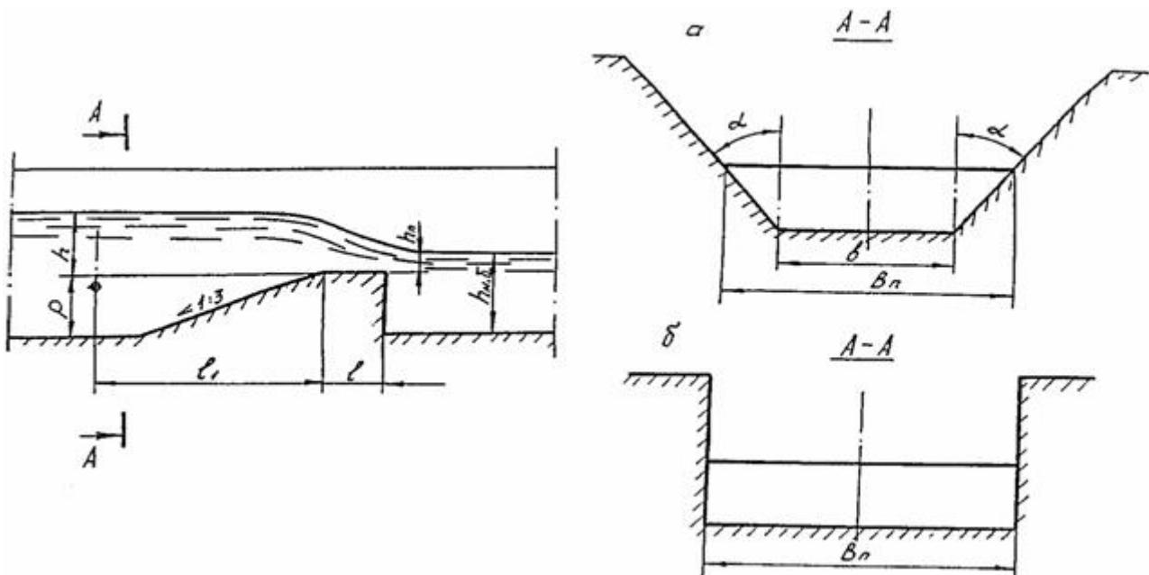
а - в каналах трапецидального поперечного сечения
