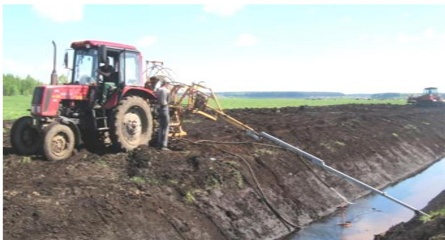
Рисунок 3. Дренопромывочная машина УПД-120 с направляющим устройством УНТ-6.
