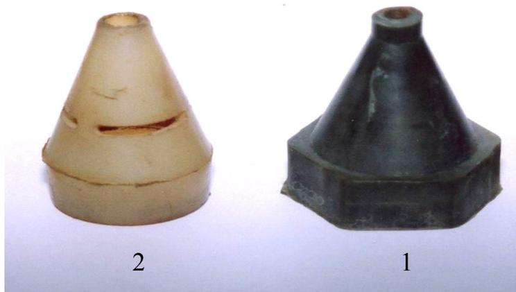
**Рис. 1. Конструкции насадков гидравлического рыхлителя**
