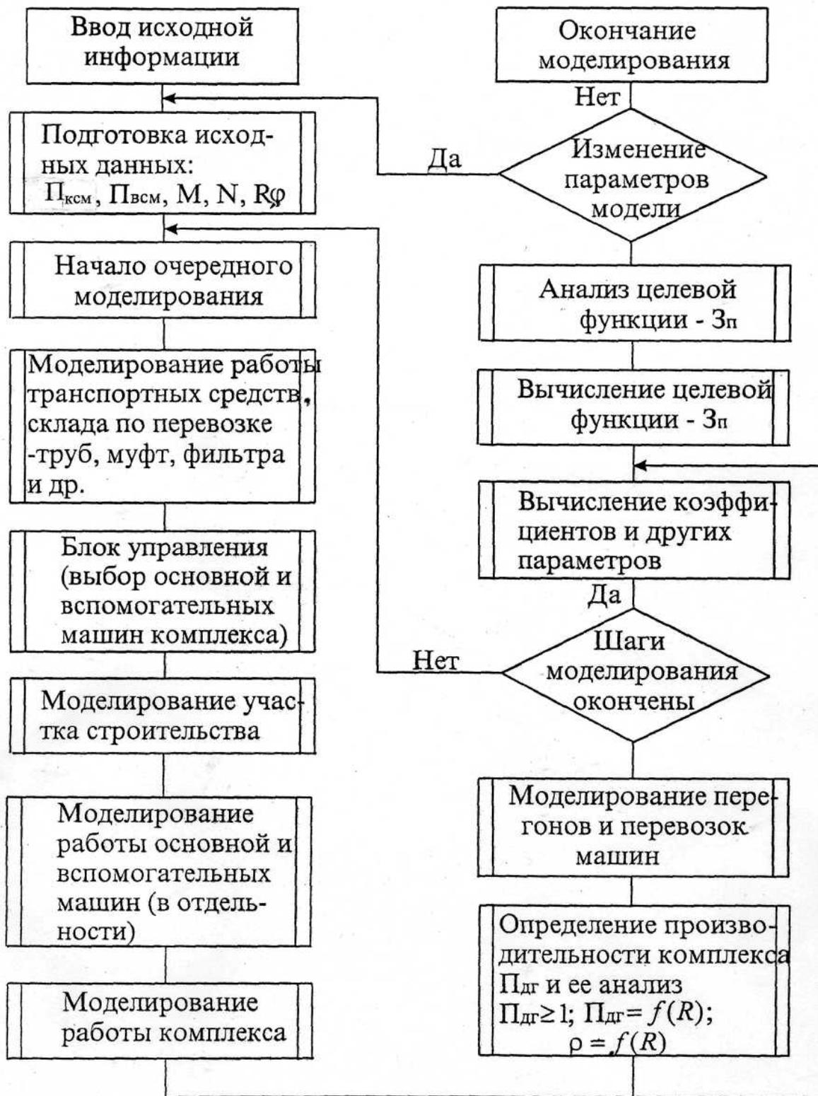
Рис. 1. Блок-схема алгоритма моделирования работы коллекторукладочных машин
