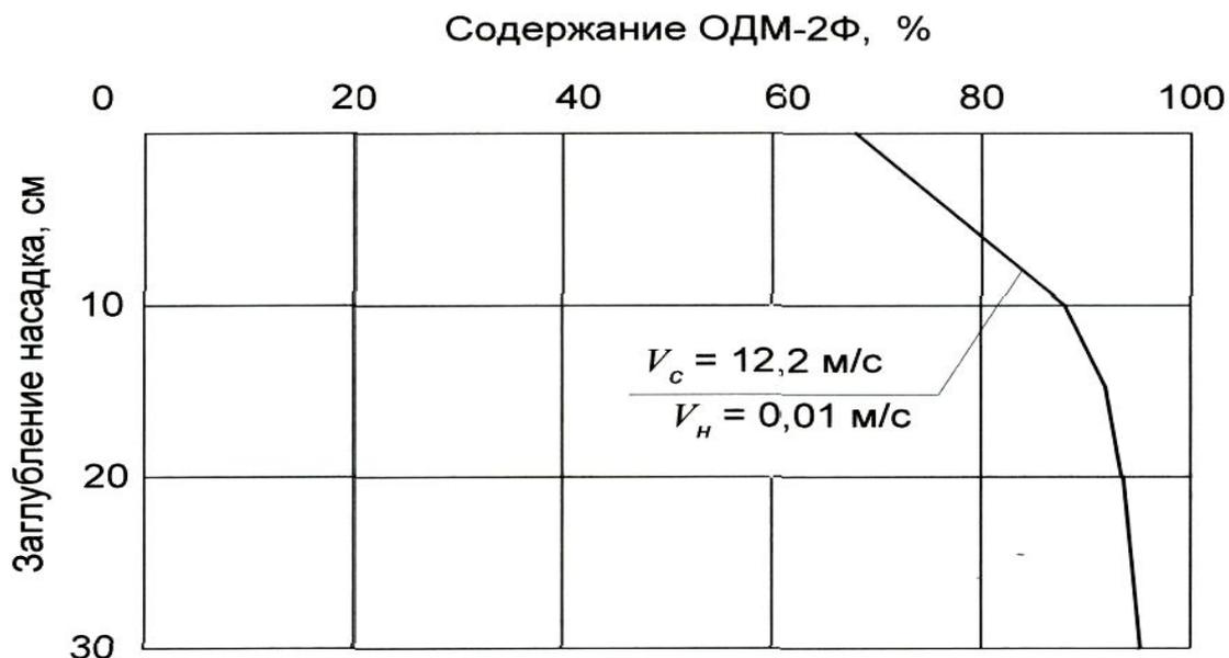
**Рис. 2. Распределение ОДМ-2Ф в верхнем слое загрузки в зависимости от заглубления насадка**
