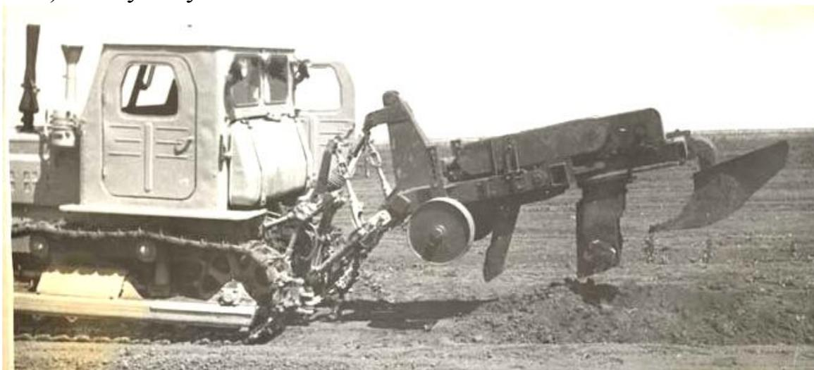
**Рис. 1. Почвенно-мелиоративное ротационно-фрезерное орудие для обработки почвы ПМС-70**
