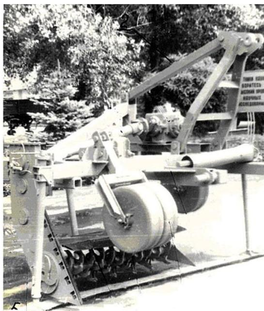
**Рис. 4. Почвенно-мелиоративное ротационно-фрезерное орудие для обработки почвы ФС-1,3**
