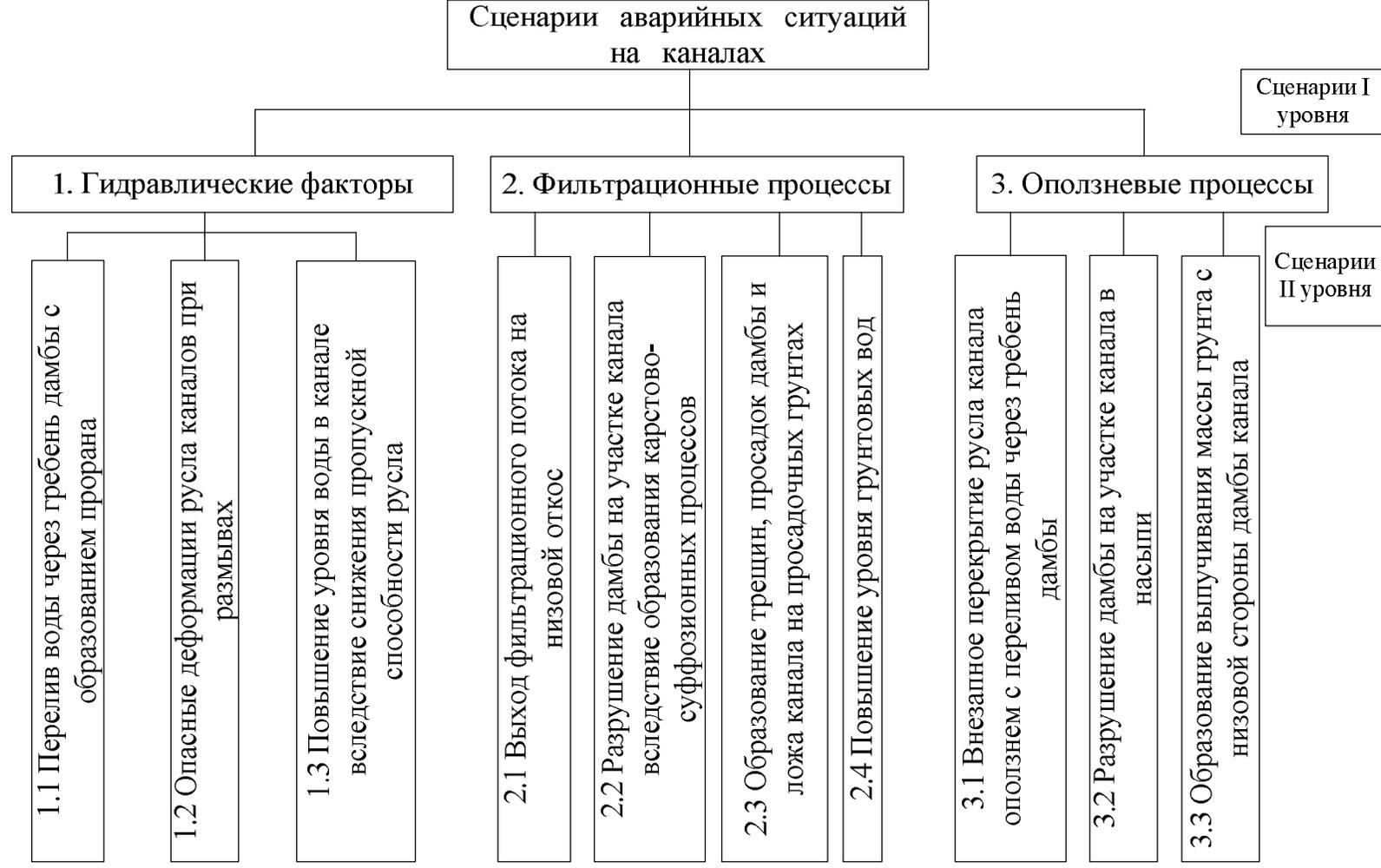
**Рис. 1. Схема возможных аварий на каналах**
