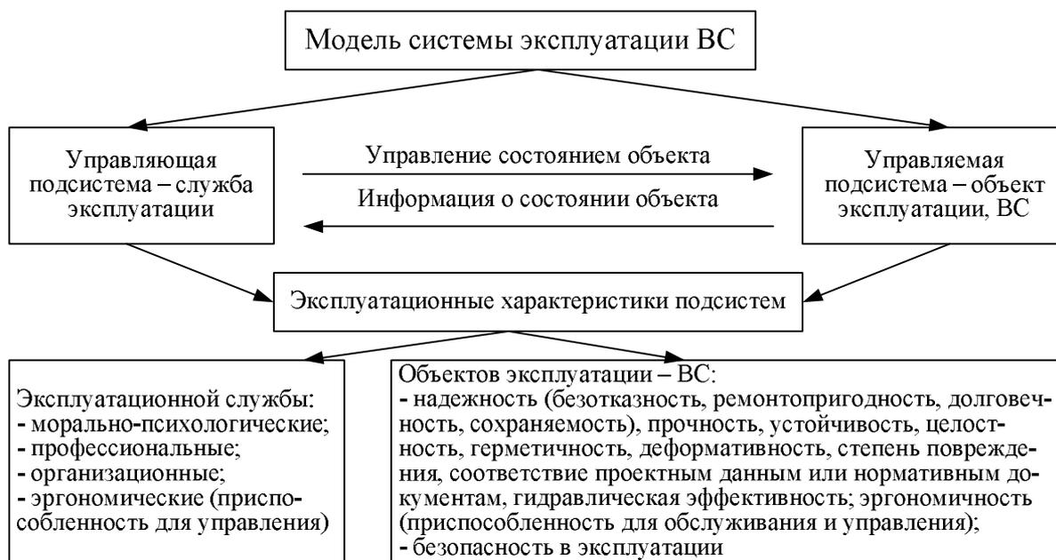
**Рис. 1. Модель системы эксплуатации ВС и их эксплуатационные характеристики**
