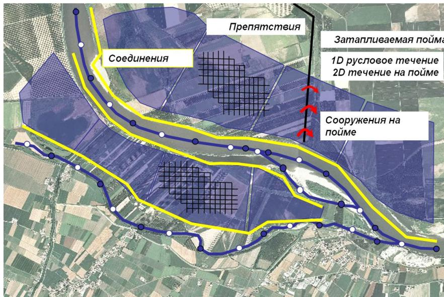
**Рисунок 5 – Общая схема составления комбинированной модели**
