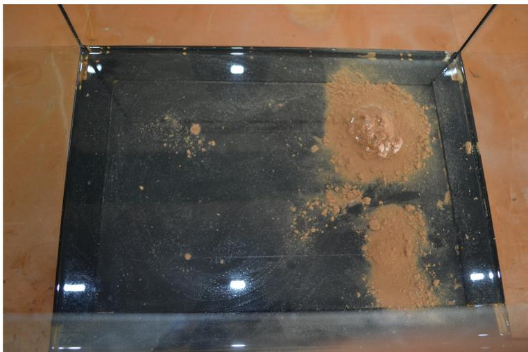
**Рисунок 3 – Выход Са-бентонита через отверстия в геомембране**
