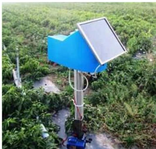
**Рисунок 4 – Базовый блок метеостанции iMetos ICA**
