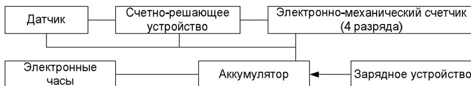
**Рисунок 5 – Блок-схема устройства нового прибора**
