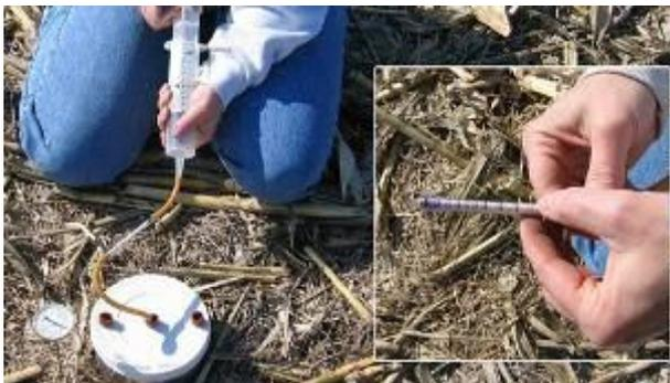
**Рисунок 1 – Определение дыхания почвы с помощью газоизмерительных трубок [7] (авторы фото Т. В. Parkin, J. W. Doran, E. Franco-Vizcaino)**
