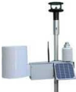
**Рисунок 3 – Метеостанция автономного мониторинга погоды**
