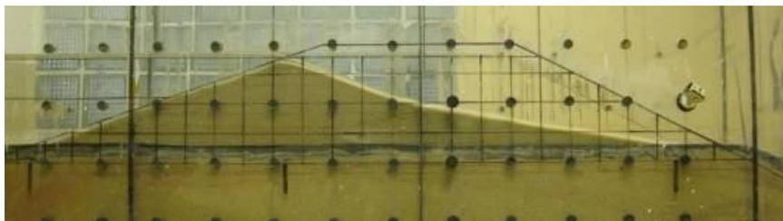
**Рисунок 1 – Модель размываемой вставки**
