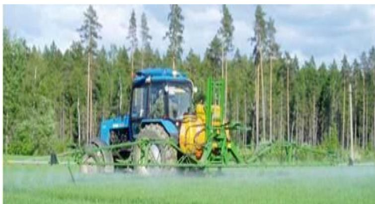
**Рисунок 1 – Навесной опрыскиватель Amazone UF 800**
