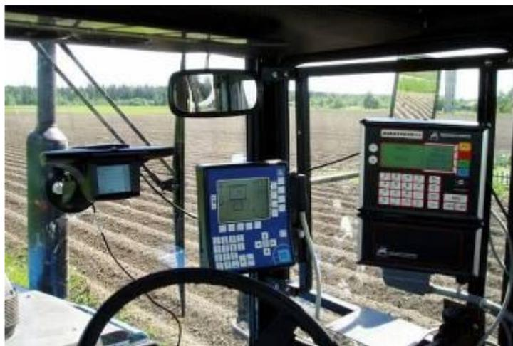
**Рисунок 2 – Бортовые компьютеры Amatron ПА и Hydro, а также контролер курса в кабине трактора**
