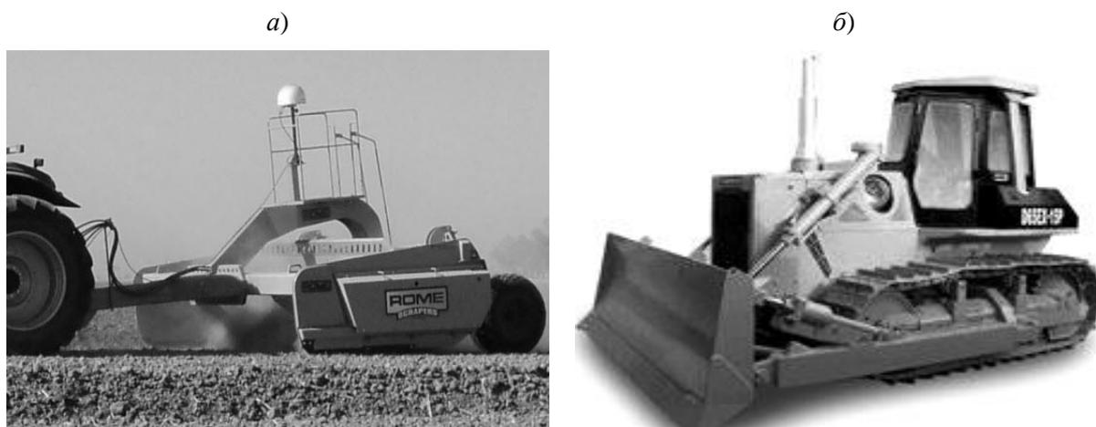
Рисунок 1 – Прицепной скрепер-планировщик СП-4,2 (а); агрегат D65EX (б)
