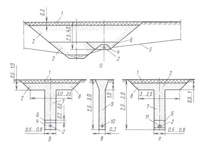
а – закрытой, устраиваемой методом «полки» (в водонасыщенных грунтах); б – закрытой с песчано-гравийным фильтром; в – бестраншейной пластмассовой; г – закрытой с минерально-волокнистым фильтром;
