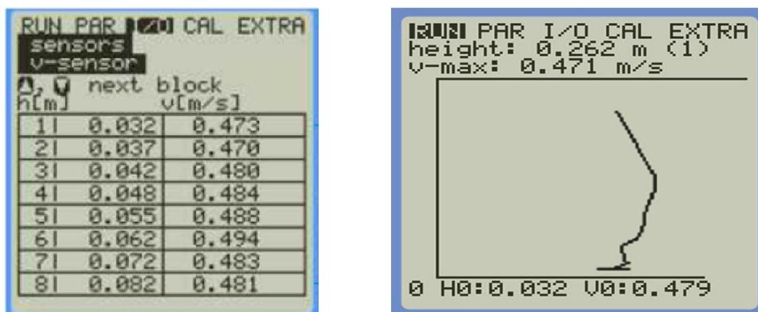
**Рисунок 9 – Реальная эпюра скорости потока (источник: <http://petrospec.ru/ultrazvukovoj-statsionarnyj-raskhodomer-nivus-ocm-pro-cf>)**
