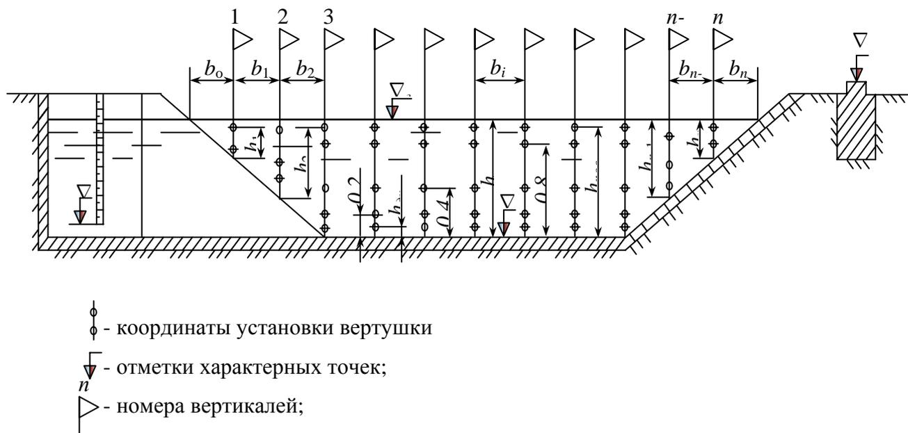
Рис. 3.6. Схема разбивки вертикалей по поперечному сечению канала
