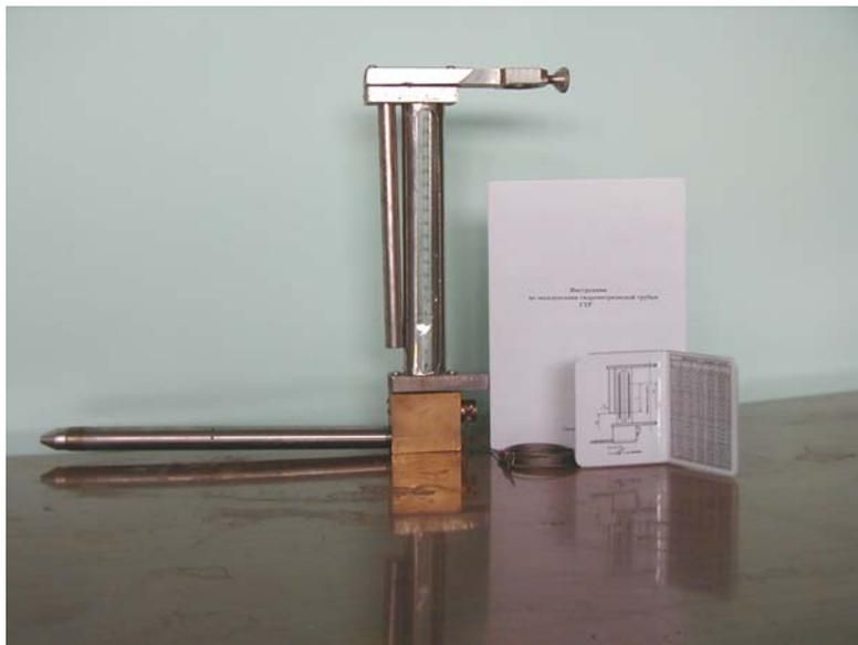
Рис. 3.4. Гидродинамический измеритель скорости потока ГТР
