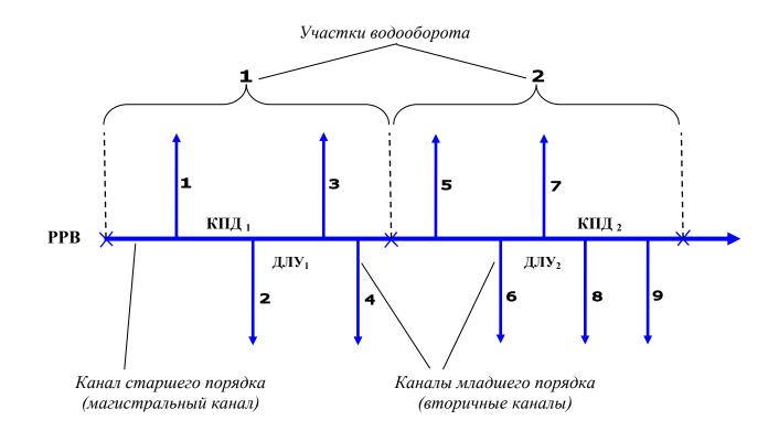
Рис. 4. Схема организации двухтактного водооборота.
