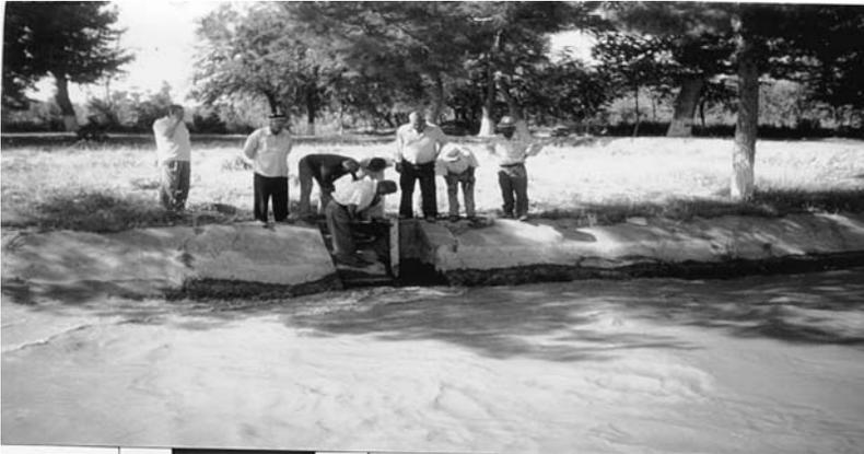
**Фото 9.3** Определение расхода воды на гидропостах по водомерным рейкам
