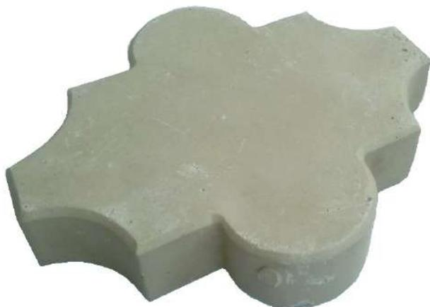
Рис. 2. Тротуарная плитка из серобетона
