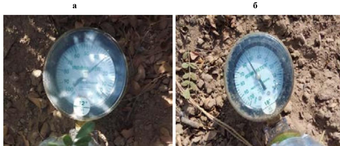
Рис. 4. Датчики влажности, установленные глубине 15 (а) и 30 (б) см
