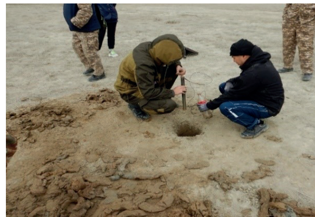
Бурение и опробование картировочной скважины № 12 глубиной 5,2 м
