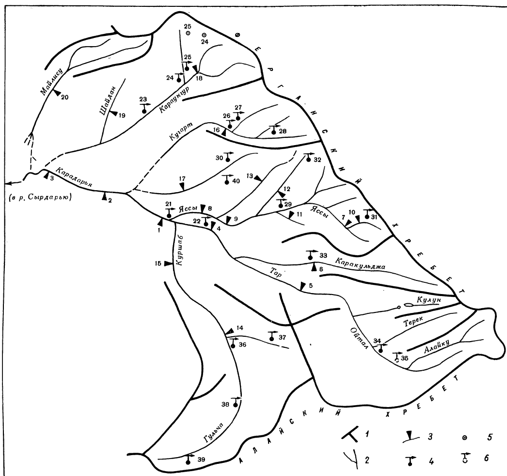
Рис. 28. Схема расположения гидрологических постов, метеорологических станций и постов и суммарных осадкомеров в бассейне р. Карадарья.
