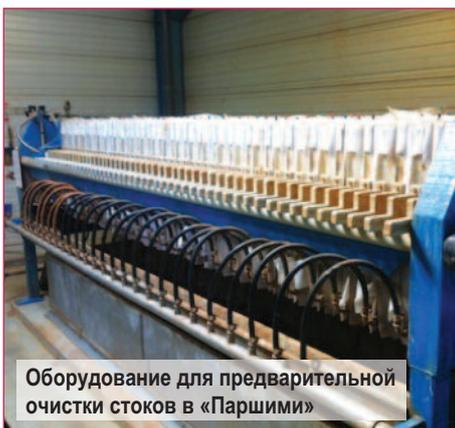
Оборудование для предварительной очистки стоков в «Паршими»
