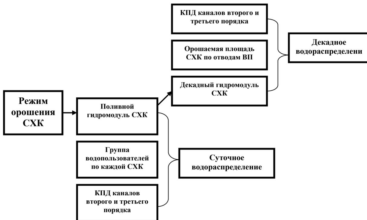
**Рис. 2. Определение суточной и декадной потребности воды СХК**
