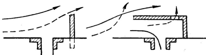
Рис. 135. Короткие водозахватные шпоры.
