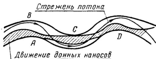
Рис. 25. Движение донных наносов на изгибе реки.
