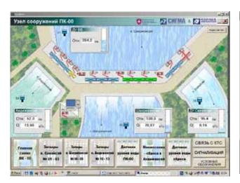
Рис. 7. Кампирраватский гидроузел главная мнемосхема системы SCADA
