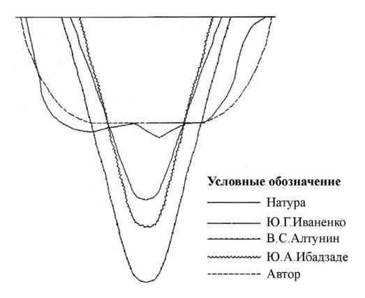
Рис.2. Поперечное сечение Каракумского канала
