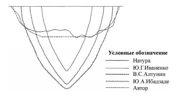
Рис.3. Поперечное сечение Волго-Каспийского канала
