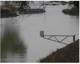
Рис. 4. Установка датчика уровня воды
