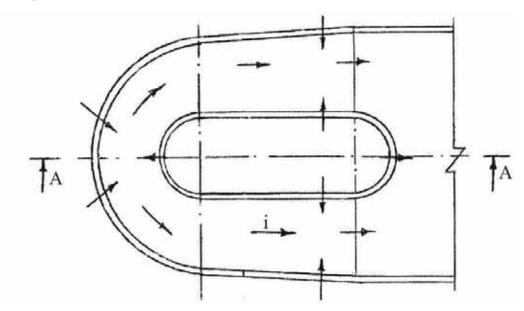
Рис. 1. План и разрез новой конструкции траншейного водоприемного оголовка поверхностного водосброса
