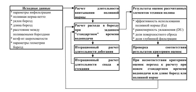
Рис. 1. Блок-схема расчетов, реализуемых моделью SIRSAN-II
