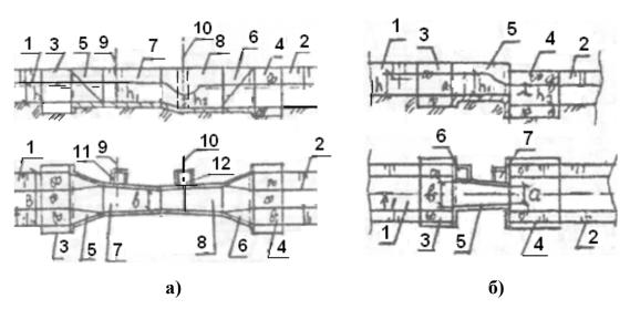
Рис. 2 Водомерные лотки:
