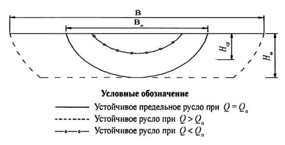
Рис. 1. Расчетная схема
