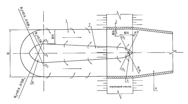
Рис. 2. Усовершенствованная конструкция траншейного водоприемного оголовка водосброса
