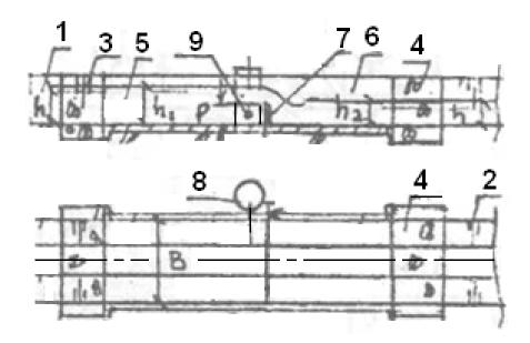
Рис.4. Лоток-водомер с водосливом треугольного профиля
