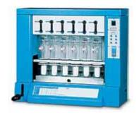
Экстрактор SER 148/6 фирмы VELP позволяет количественно отделить вещество или группу веществ от смеси твердых или полутвердых тел. Экстракция выполняется по методике Рэндалла, в два шага с последующим удалением использованного растворителя, что позволяет избежать сильного загрязнения окружающей среды. Прибор управляется программируемым микропроцессором с 29 настраиваемыми программами. Два независимых дисплея постоянно
