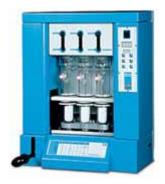
Экстрактор SER 148/3 фирмы VELP позволяет количественно отделить вещество или группу веществ от смеси твердых или полутвердых тел. Экстракция выполняется по методике Рэндалла, в два шага с последующим удалением использованного растворителя, что позволяет избежать сильного загрязнения окружающей среды. Прибор управляется программируемым микропроцессором с 29 настраиваемыми программами. Два независимых дисплея постоянно отображают фактическую температуру и ос-
