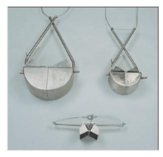
Пробоотборник используется для отбора донных отложений со дна водоемов (рек, озер и т.п.) на достаточно больших глубинах (до 40 м)
