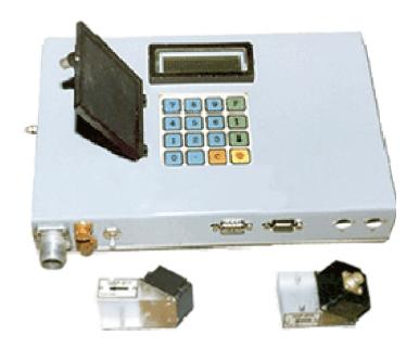
Расходомеры УДР-011 работоспособны на трубопроводах, изготовленных из стали, чугуна, асбестоцемента, пластика и т. п.
