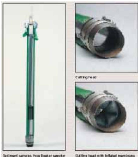
Пробоотборник Бикера позволяет быстро и качественно отбирать пробы донных отложений, сохраняя при этом структуру образца. Возможная длина образца – 1 и 1,5 м. Резиновая мембрана, которая надувается с помощью насоса, позволяет образцу удерживаться внутри пробоотборника. Наличие поршневого механизма обеспечивает полное заполнение пробоотборника.
