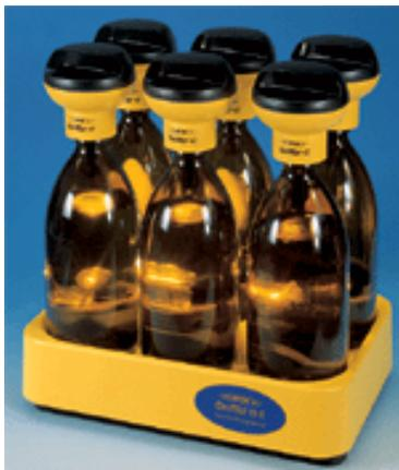
Запатентованная манометрическая система с датчиками давления
