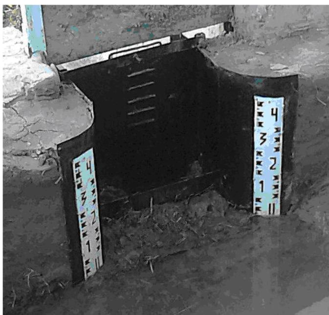
**Рис. 2. Шлюз-водомер в процессе испытаний**
