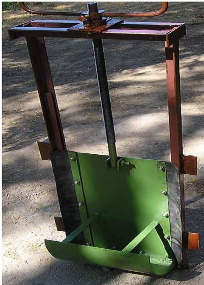
**Рис. 1. Общий вид металлической части шлюза-водомера**
