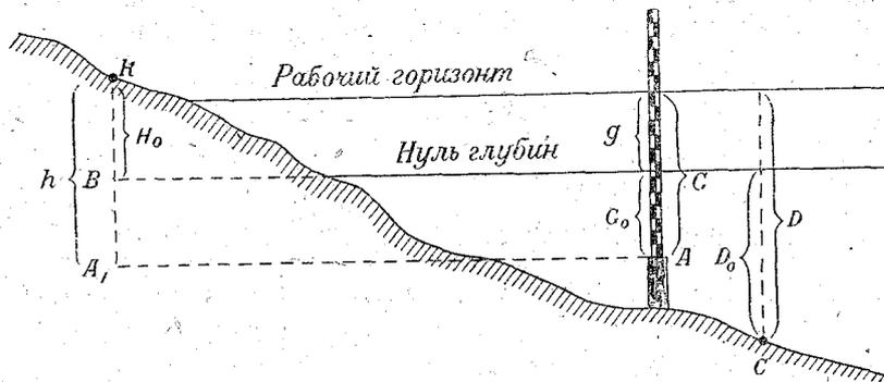
Рис. 20. Схема приведения измеренных глубин к нулю глубин.
