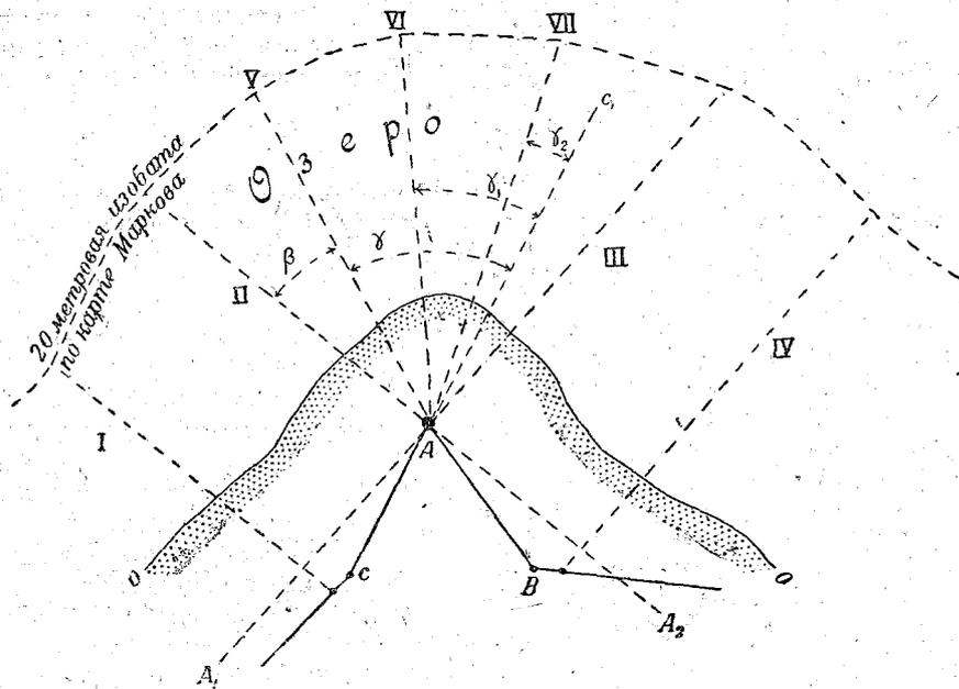
Рис. 15. Схема шляпочного промера „звездочкой“.
