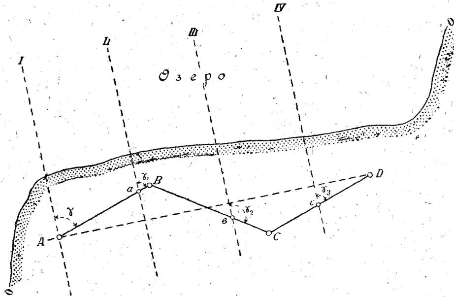
Рис. 14. Распланировка галсов шлюпочного промера по створам.
