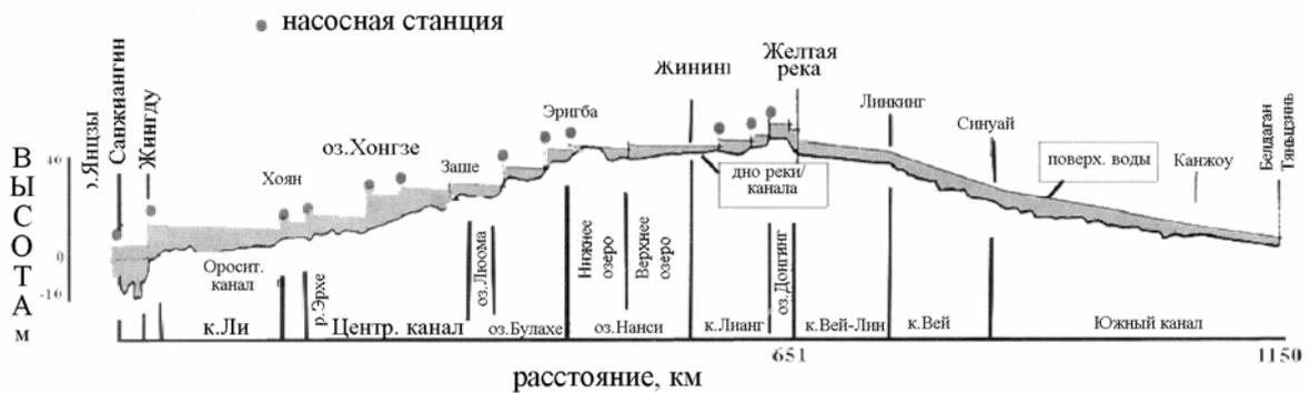
Рис.2. Профиль Восточной магистрали проекта переброски воды с юга на север
