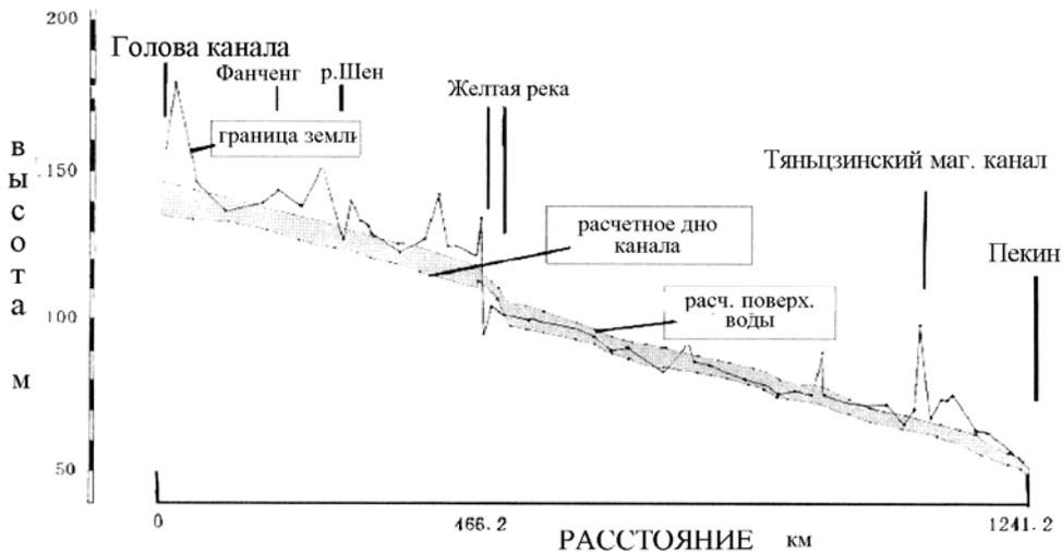
Рис.1. Профиль Центральной магистрали проекта переброски воды с юга на север
