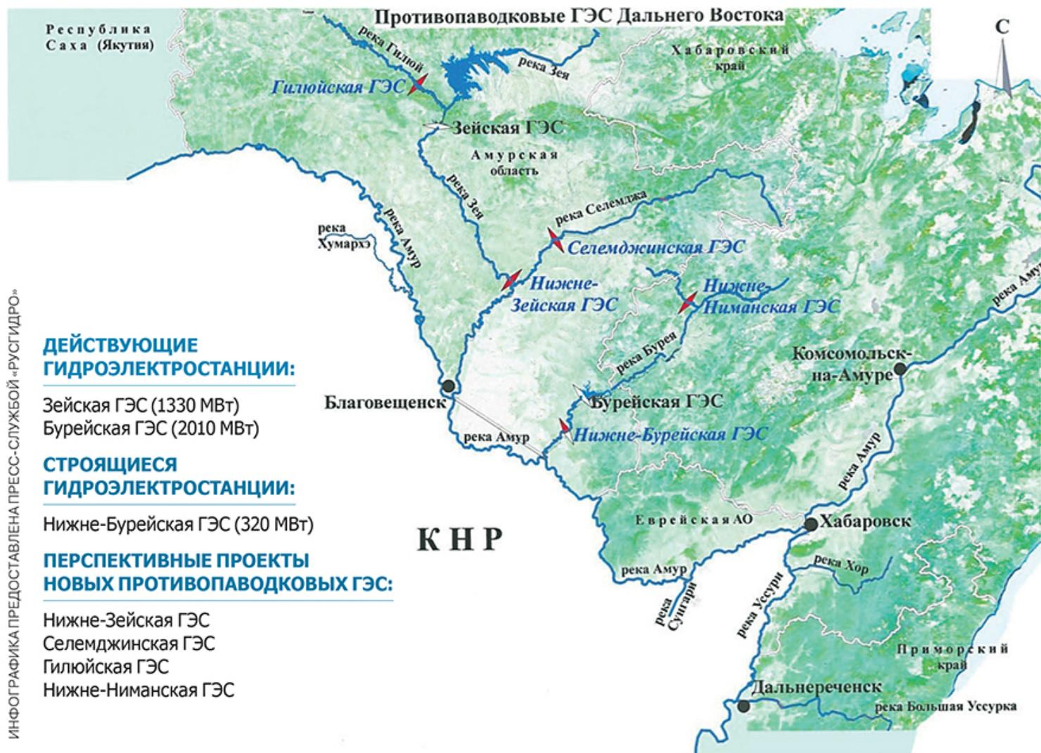
Рис. 11. Одна из схем предлагаемых Русгидро противопаводковых ГЭС
