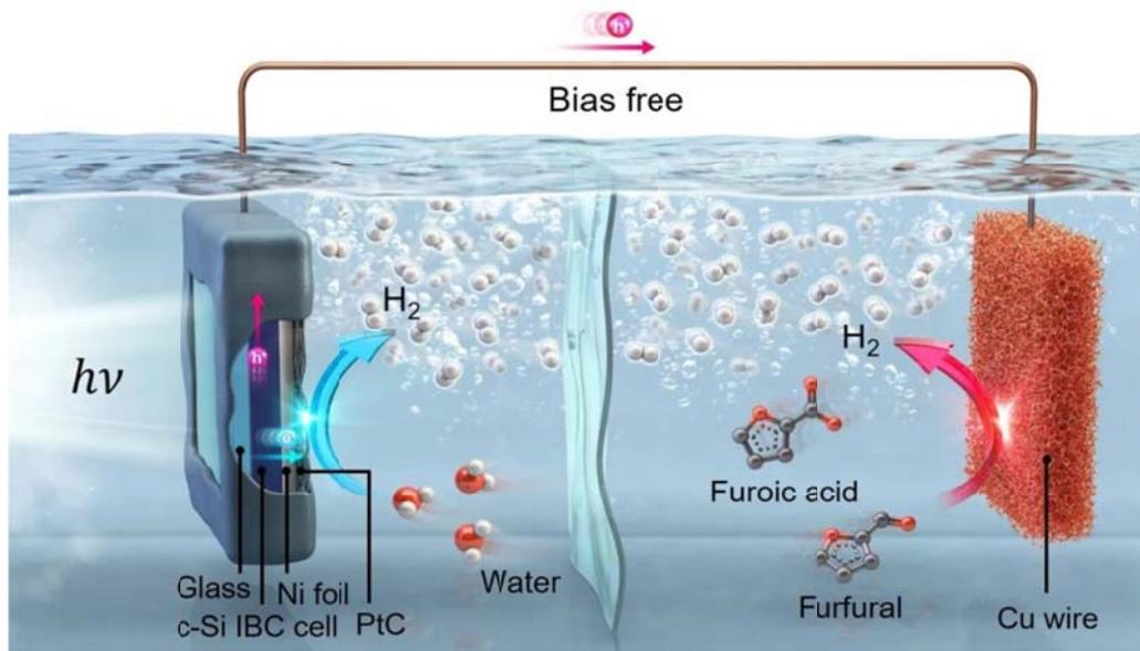
*Схема производства ФЭП  $H_2$  с использованием фотокатода PtC/Ni/c-Si*
