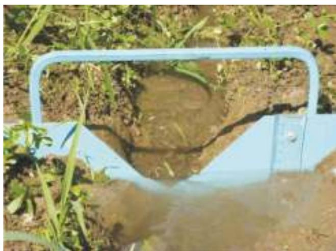
Рис. 26. Водослив Томсона (ВТ-20) для измерения расходов воды в борозду
