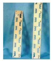
Рис. D. Рейка уровнемерная гидромелиоративная РУГ
