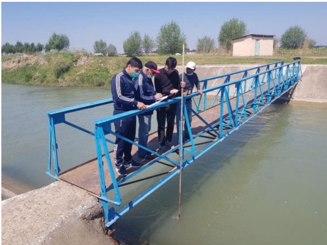
**Рис. 1. Измерение расхода воды на головном гидропосту канала РК-10**
