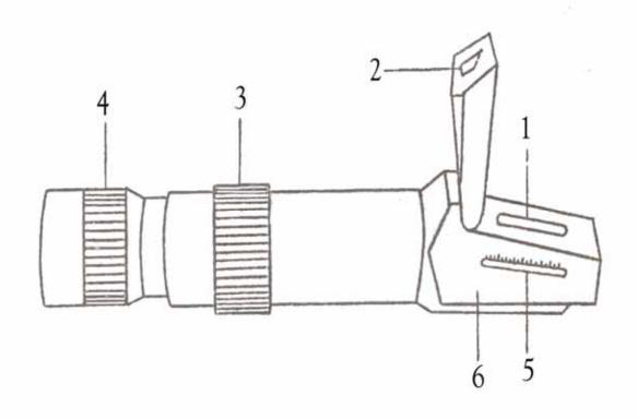
Рис.1. Ручной рефрактометр: 1-измерительная призма; 2-откидная призма; 3 - кольцо переключение шкалы; 4 - оправа окулятора; 5-термометр; 6 - регулировочной винт.
