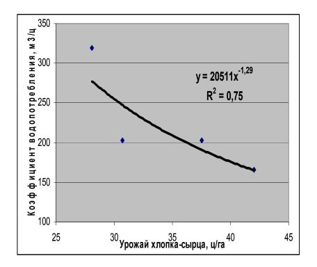
Рис. 2. Зависимость урожая хлопка-сырца (У, ц/га) от суммарного испарения (Е, тыс.м3/га) и коэффициент водопотребления (Кв, м3/ц) от урожая хлопка-сырца на светлом сероземе Согдийской области (опыты 2004-2006 г.г.)
