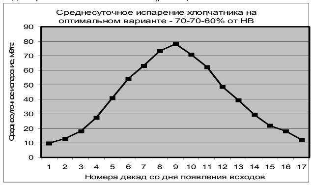
Рис.1. Среднесуточное испарение хлопчатника на оптимальном режиме предполивной влажности почвы — 70-70-60% от HB (2004-2006гг).
