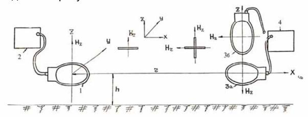
Рис.1. Устройство аппаратуры дипольного электромагнитного профилирования: 1 - передатчик; 2 - передающая антенна; 3 - приемник; 4 - приемная антенна.
