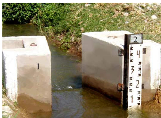
Рис. 1.4. Водомерный лоток САНИИРИ
