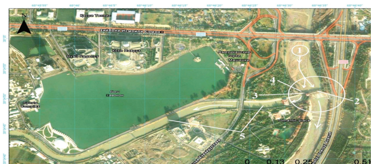
Рисунок 9. Водозаборный гидроузел (Ферганский тип) Большого Гиссарского Канала (БГК). Равнинная зона.
